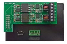
Das System kann über den USB-Anschluss am SGD mit Strom versorgt werden.
