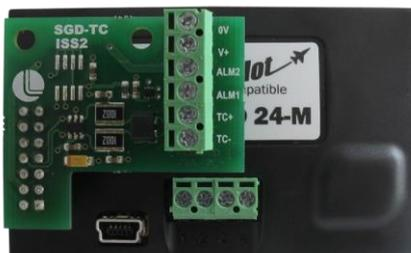
Le système peut être alimenté via le port USB au niveau du SGD.
