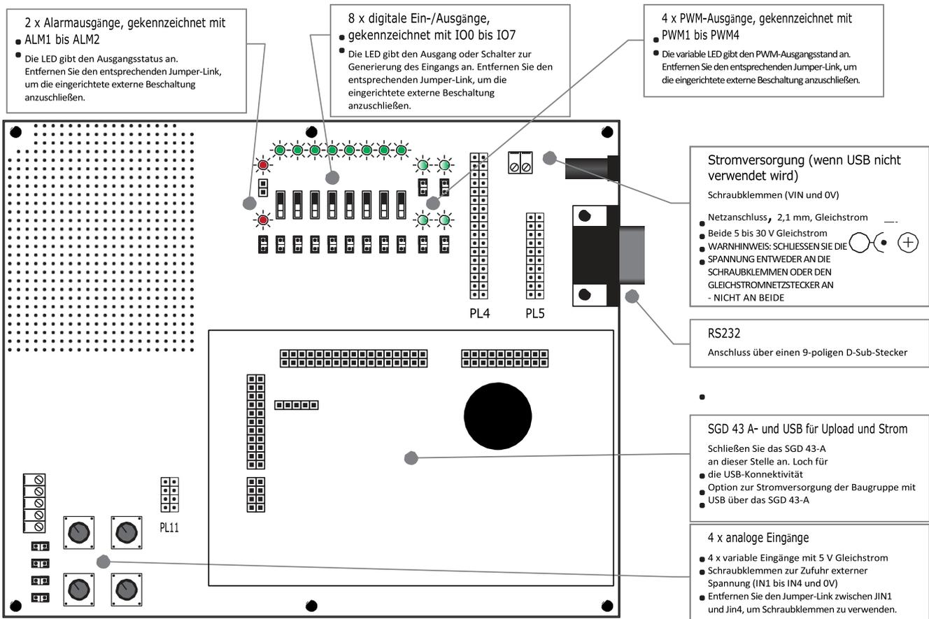
Der Hauptanschluss ist der mit dem SGD 43-A als Teil des Entwicklungskits SGD 43-A-DK+ mitgelieferte Anschluss. Die Baugruppe kann direkt durch Anschließen eines USB-Kabels an der Rückseite des Displays mit Strom versorgt werden. Bei bestehender Verbindung werden sowohl das Display als auch die Entwicklungsbaugruppe über USB mit Strom versorgt.
