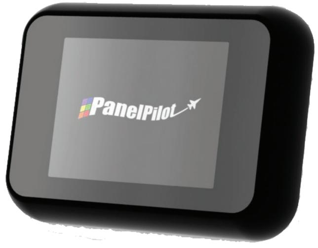
SGD 24-M-IP は、320 x 240 ピクセル (QVGA) のカラー画面と、USB プログラミングインターフェイスを搭載した PanelPilot 互換 IP-67 グラフィックディスプレイです。
